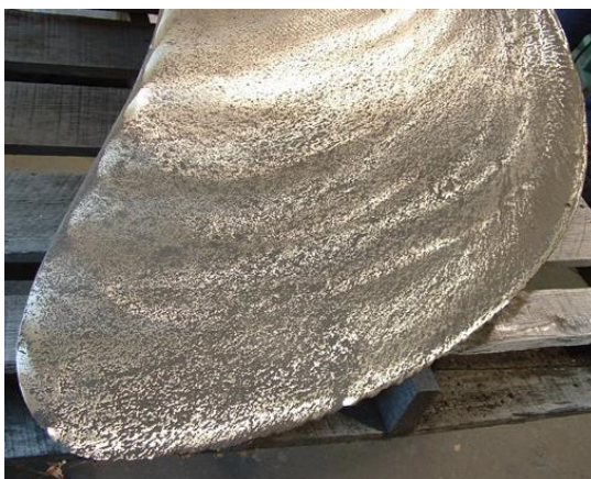
Figura 10 - Hélice danificado devido ao efeito de cavitação.
