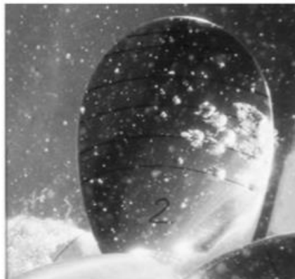
Figura 9 - Bolhas de vapor formadas na pá de um hélice.
