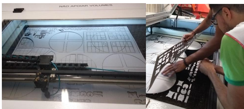
Figura 23 – Corte a laser do protótipo.
