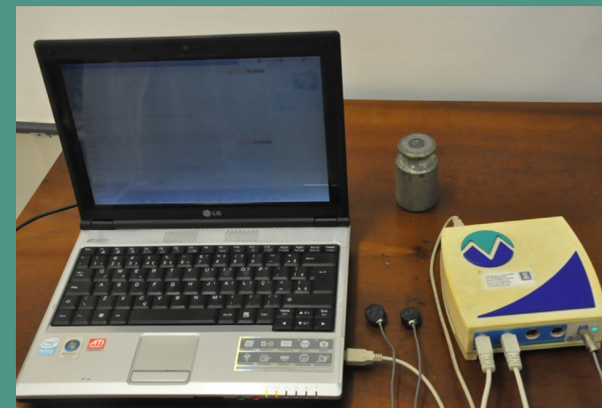
Figura 3. Transdutor de força de mordida e suas células de carga
